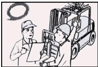
No opere una carretilla dañada o defectuosa. Una carretilla realizará bien su trabajo únicamente cuando se encuentre en las condiciones de trabajo adecuadas.
