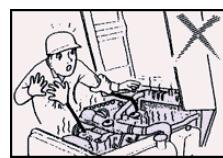
Apague el motor y deje que el motor y el radiador se enfrien antes de hacer una inspección. Use un trapo grueso y guantes para protegerse si fuera necesario. Párese a un costado, proteja su cara y abra lentamente la tapa.
