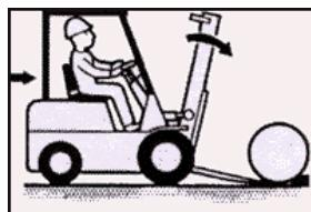
2. Incline el mástil de modo que las horquillas puedan deslizarse por el suelo, debajo del objeto que debe levantarse.
