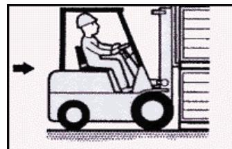
1. Acérquese lentamente a la carga y detenga la carretilla a 20/30 cm. (8/12 pulg.) de un lado de la carga. Asegúrese de que la carretilla quede perpendicular a la carga y que las horquillas están a la altura correcta.
