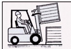
1. Verifique que la carga esté centrada en las horquillas e incline el mástil completamente atrás.
