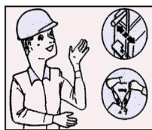
Asegúrese de que la palanca de moverse hacia adelante o hacia atrás está en NEUTRAL y que el freno de mano está colocado del modo apropiado.
