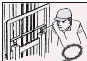
Si los topes de las horquillas no están bien colocados, éstos pueden salirse de su posición y provocar que las cargas queden descentradas o inestables.
